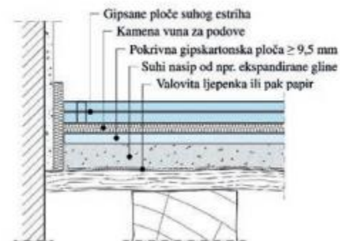
Primjer spoja sa zidom na podlozi od drva
