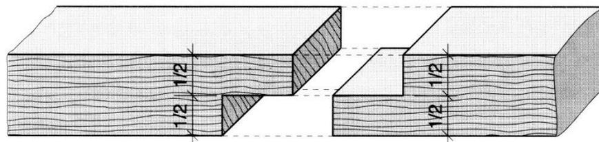
*Jednostavni prijeklop – tlačno čvrst, bočno pomičan spoj*
