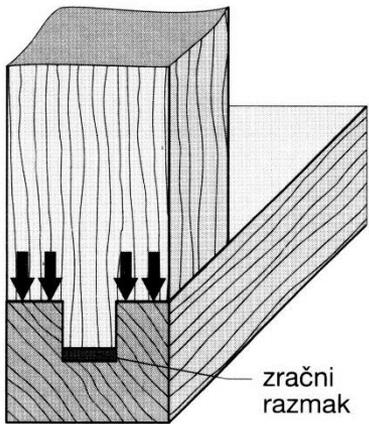
Prijenos tereta pri spoju na čep u dvjema trećinama plohe poprečnoga presjeka
