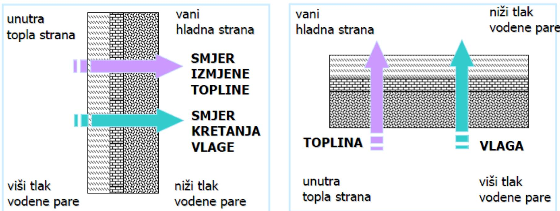
Transport vlage se odvija u smjeru pada tlaka: od mesta višeg parcijalnog tlaka vodene pare prema mjestu nižeg parcijalnog tlaka vodene pare – uvijek u smjeru transporta TOPLINE.
