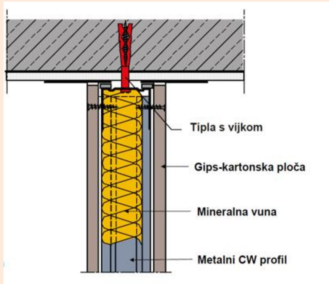
načini priključaka montažnog zida na montažni strop:
