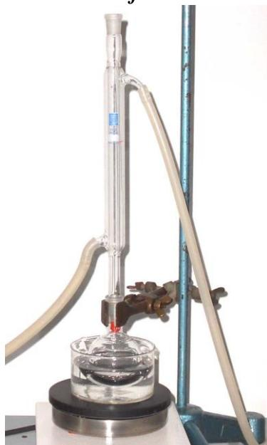
*Slika 3.* Aparatura za refluksiranje
