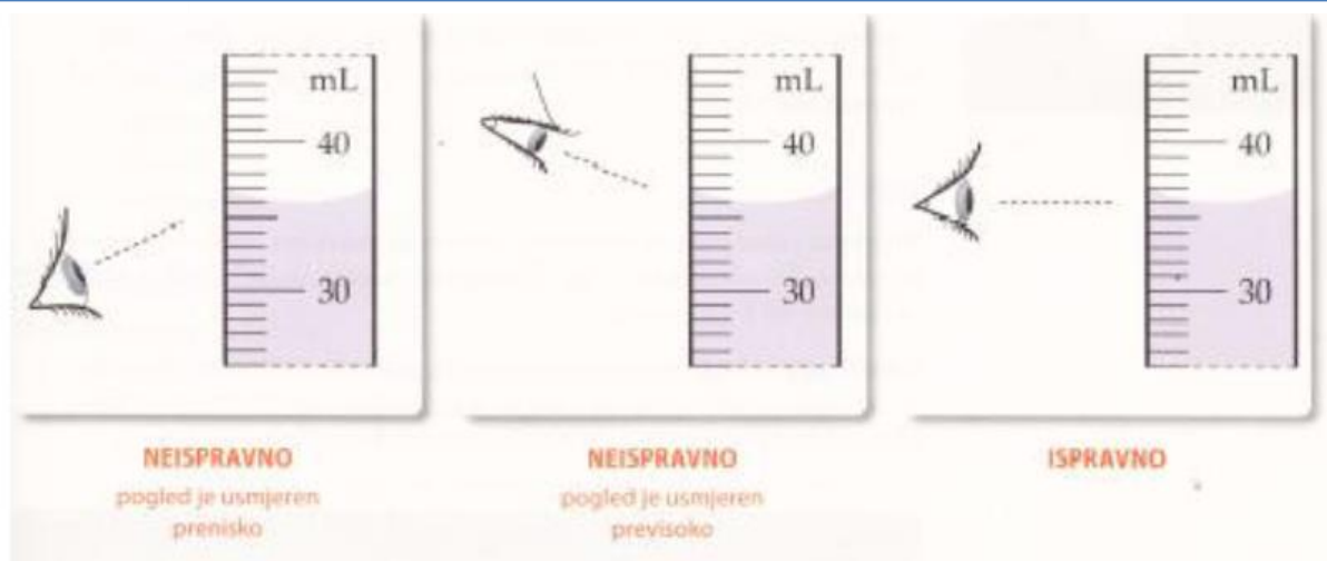
Slika 11.2 . Pravilno očitavanje volumena u odmjernom posuđu
