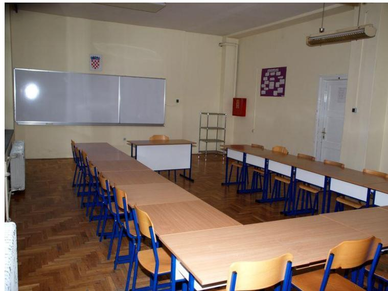
Važna je i osvjetljenost učionica - treba puno svijetla ali bez velikih kontrasta, koja mora doći s lijeve strane, površina stakla bez prečki mora biti 1/4 - 1/3 površine poda, prozori bi trebali biti bez nadvoja ( strop služi kao površina koja reflektira svjetlost ). Školsku ploču je potrebno direktno osvijetliti posebnim, usmjerenim svjetlima, da ne blješte.
